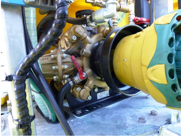
Abb. 6: Die Pumpe Comet IDS 1701 wird über eine Weitwinkelgelenkwelle angetrieben.
