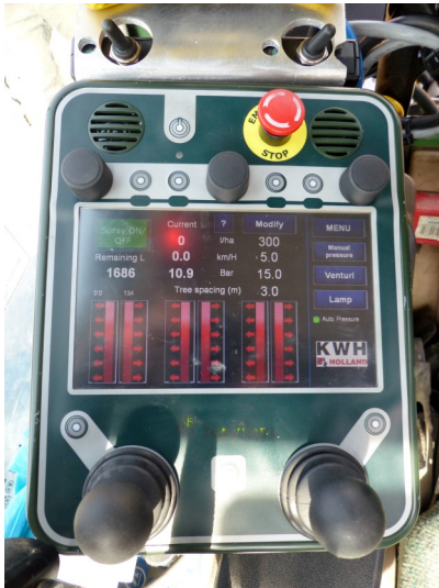
Abb. 16 (links) : Das Terminal wird mit einer Halterung im Griffbereich des Schlepperfahrers montiert. Abb. 17 (oben): Die Steuerung der Recyclingeinrichtung erfolgt über ein Zusatzterminal.
