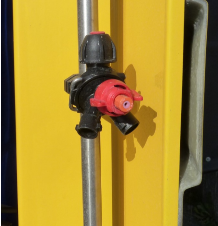
Abb. 13: Flüssigkeitsverteilung durch Dreifachdüsenkörper mit Membranventil
