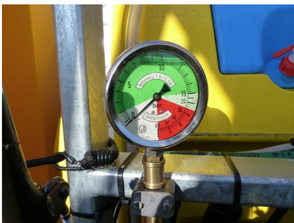
Abb. 19: Das Manometer im Frontbereich mit 100 mm Durchmesser.
