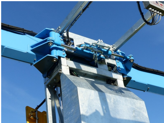
Abb. 7 und 8: Die Luftverteilrohre bilden gleichzeitig das Traggestell für die Luftverteiler aus GFK (oben). Das Überzeilengestänge wird hydraulisch geklappt (links).
